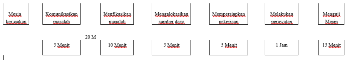
Gambar 5 MVSM Current State Map Mesin Bubut Sebelum Perbaikan
