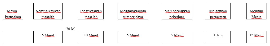
Gambar 1. MVSM Current State Map Mesin Bubut Sebelum Perbaikan
